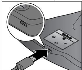
Schließen Sie das eine Ende des USB-Verbindungskabels an die USB-Anschlussbuchse und das andere Ende an einen Computer an.
